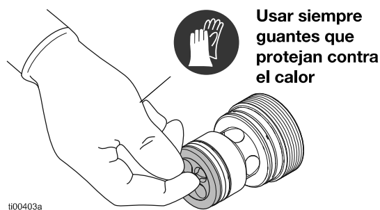
FIG. 85: Consejo para montar el asiento de retención
